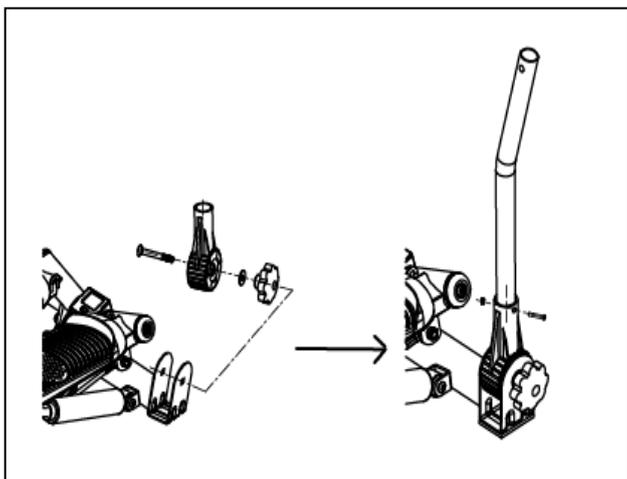
2: Installieren Sie die Halterung für die Griffe (Teil Nr. 29) auf beiden Seiten indem Sie diese in die vorgesehenen Plätze stecken und anschließend mit einer Schraube und den Plastikgriffen (Teil Nr. 31) verschrauben. Nun verschrauben Sie den unteren Teil der Griffe (Teil Nr. 35).
